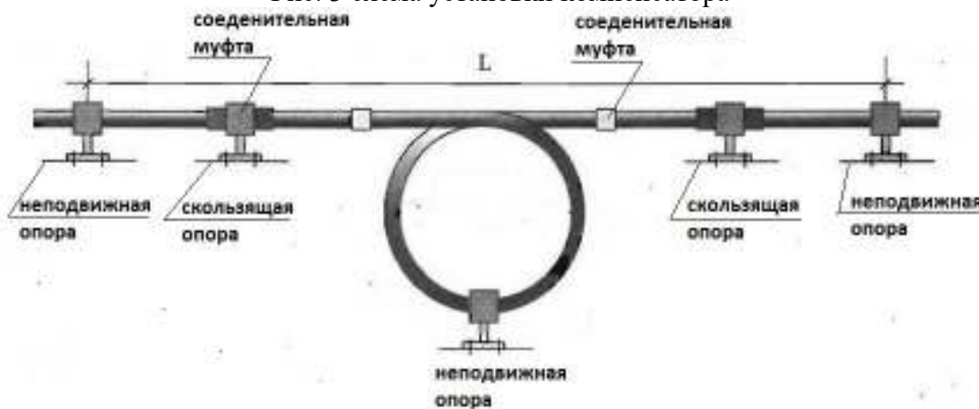
Рис. 3 схема установки компенсатора
